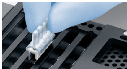
Encaje el clip de tornillos en el módulo y retire la cubierta
